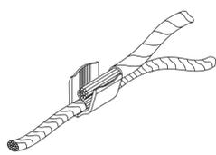
**D)** Isolare la crimpatura tramite nastro isolante nero
